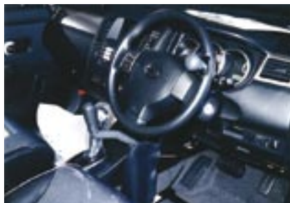
障害者でも運転しやすいように改造されたハンドルと駆動装置
